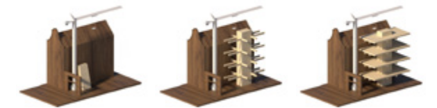
Voorhof dient tijdens de constructie als kleine bouwplaats
